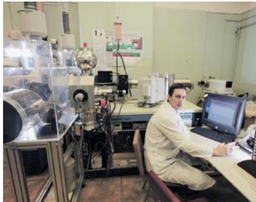
Масс-спектрометр Triton контролирует качество топлива для быстрых реакторов
