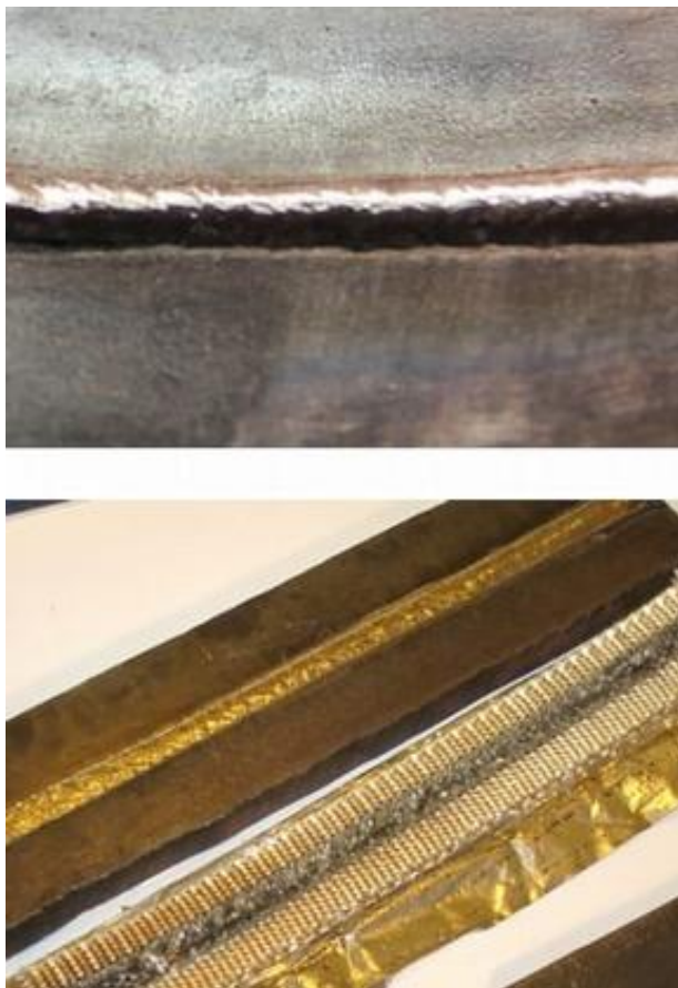
Рис. 5. Обратный валик и внешний вид ленты после сварки трубного (сверху) и прямолинейного стыка (снизу) образца резервуарной секции
