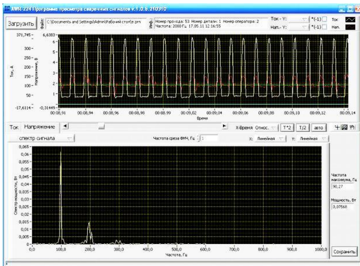
Рис. 1. Осциллограмма и АЧХ режима сварки Esab Pulse
