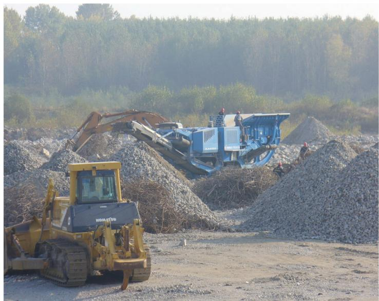
Рис. 7: Дробление бетона и железобетона на щебень с отделением арматуры
