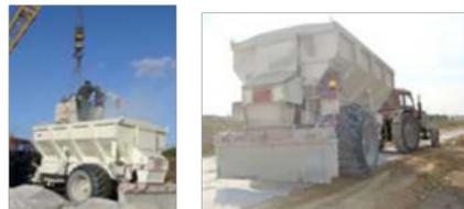
Внести полифилизатор «ПГСП 3» (40 % расчетного количества) на глубину 15 см
