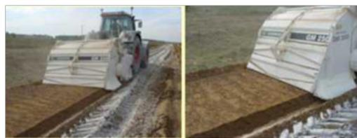
Перемешать внесенные полифилизаторы на глубину 15 см
