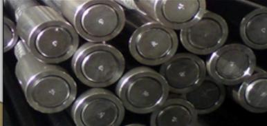
Торцовка конца арматуры нужна для равномерного распределения нагрузки при ковке и правильной работе соединения в конструкции.
