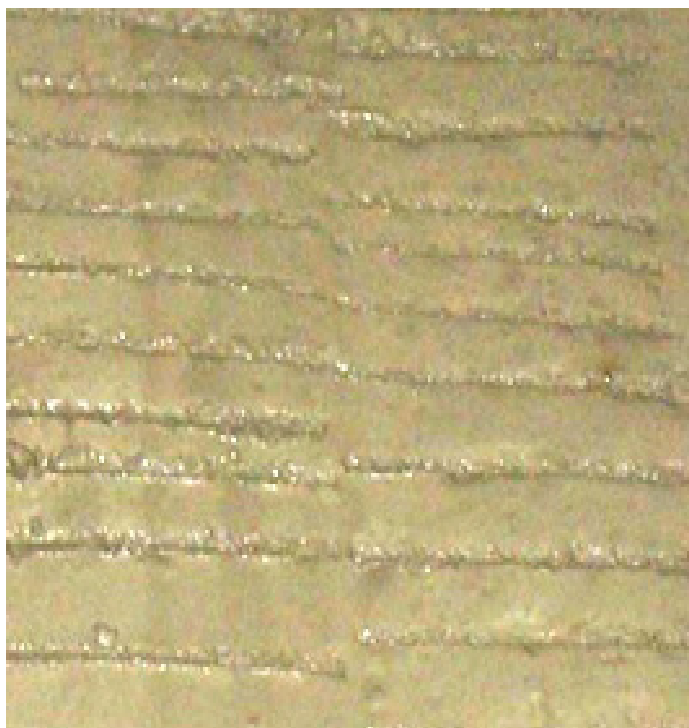
Рисунок 2 – Рифленая поверхность листа сталефибробетонной несъемной опалубки
