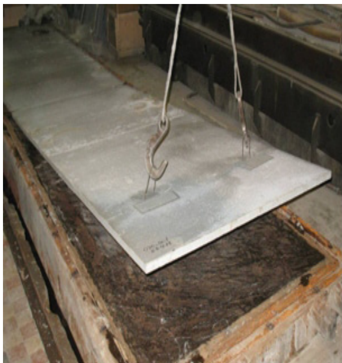
Рисунок 1 - Распалубка сталефибробетонного листа толщиной 30 мм
