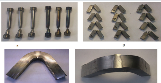
Рис.10 Образцы после испытаний: а – на растяжение; б – ударный изгиб; в – статический изгиб
