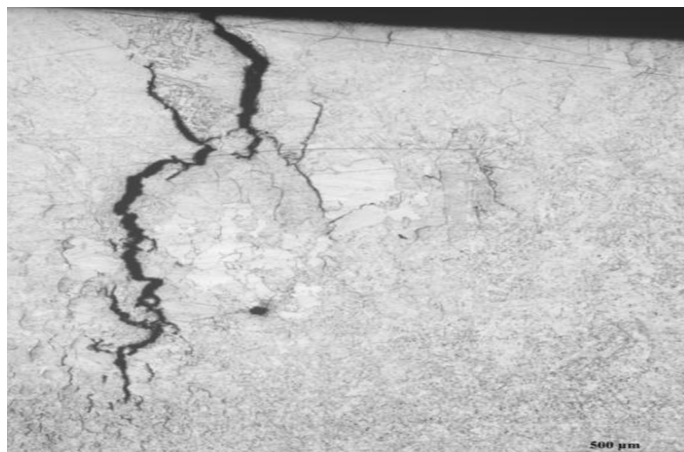
Рис.5 Крупные зерна и многочисленные трещины по их границам
