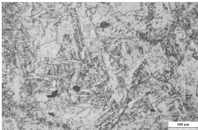
Рис.4 Игольчатый феррит (видманштетт) в металла образца №3-2
