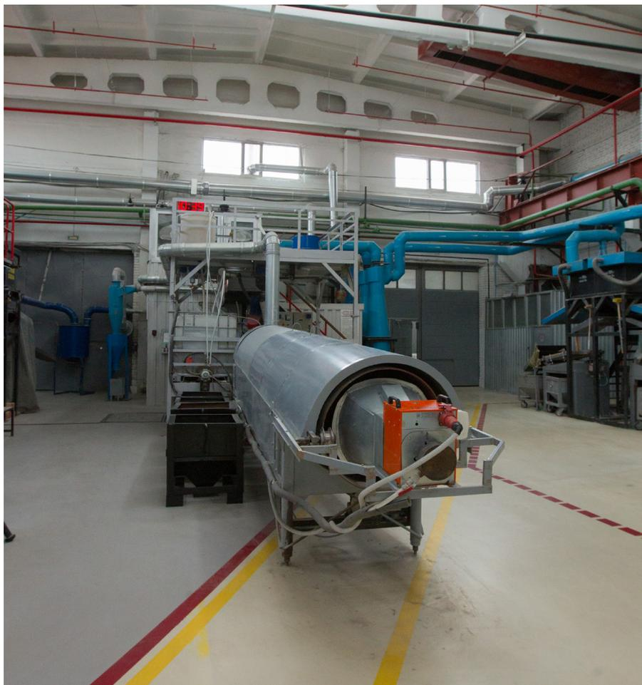
Оборудование для производства специальных материалов для наливных полов АЭС
