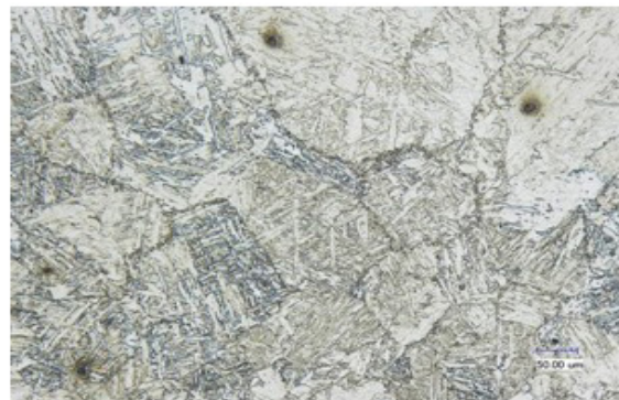
Рис.3. Крупнозернистая структура в сварном соединении
