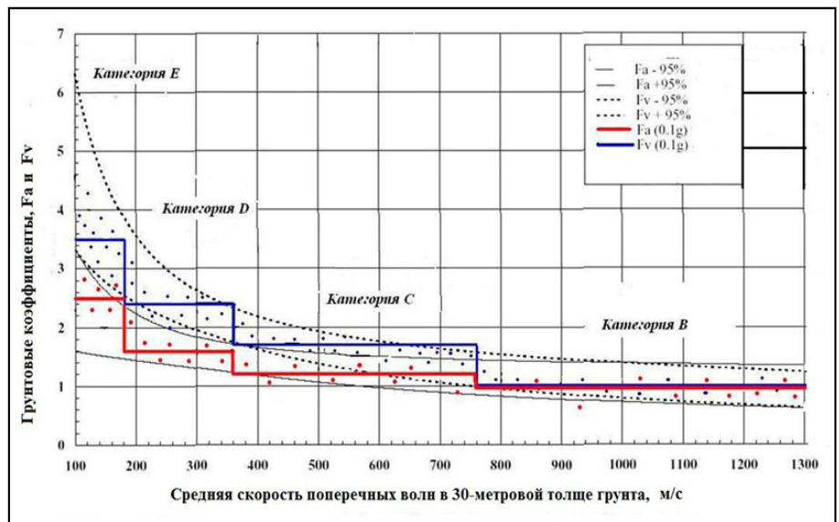
РИС.1 Зависимость грунтовых поправок от величины скоростей поперечных волн
