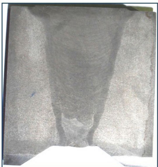
Рис.4 Мелкозернистая структура металла шва по всему сечению сварного соединения
