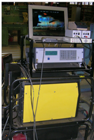
Рис.2. Трубо сварочный комплекс с дистанционным управлением СА-673
