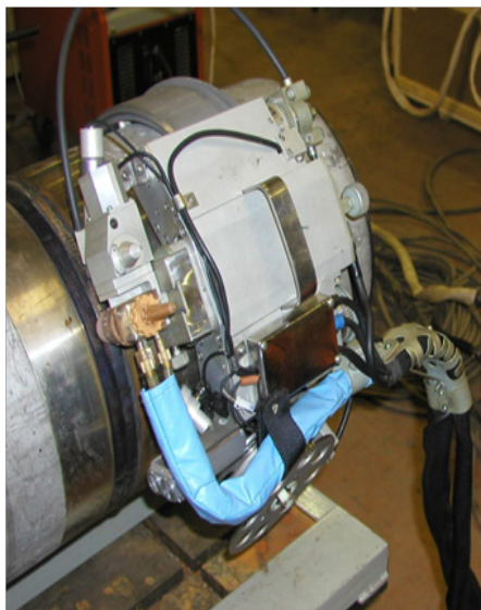
Рис.2. Трубо сварочный комплекс с дистанционным управлением СА-673
